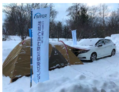
EV（日産リーフ）からテント内の可搬式給電器へ給電する様子
