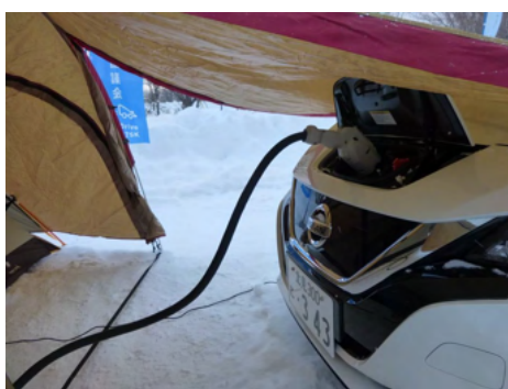
EV（日産リーフ）からテント内の可搬式給電器へ給電する様子
